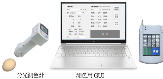
図2: 試作した測色システム[2]
