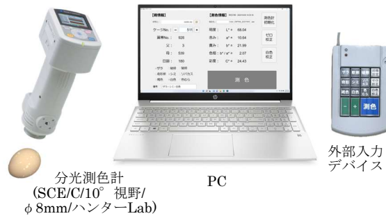
図2 卵殻測色システムの構成
